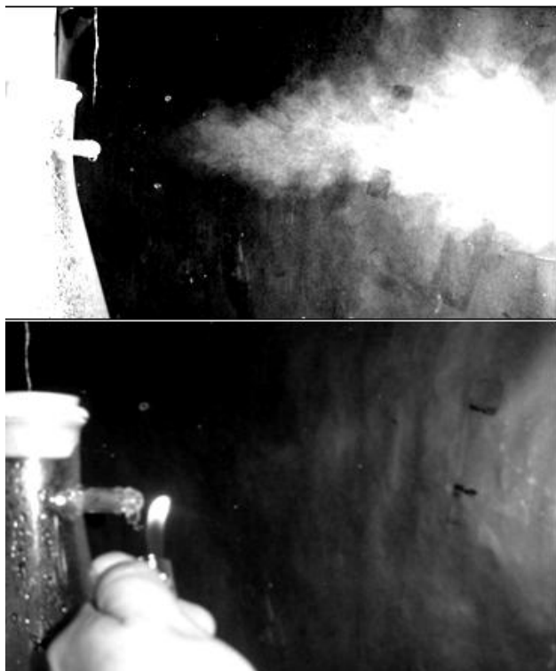
FIGURA 16. En la figura de arriba si se forma nube. En la figura de abajo se calienta el vapor que sale de la boquilla y no la nube no se forma.
