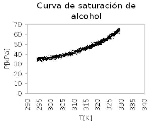
FIGURA 11. Curva de saturación que relaciona la temperatura con la presión de una sustancia pura (alcohol etílico)
