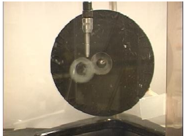
FIGURA 1. Cavidad donde se generan los vórtices anulares. Está formada por una bocina (que se encuentra en la parte trasera) y en la parte de enfrente se ha cerrado poniendo un disco compacto. En la figura se observa un anillo que se ha visualizado con humo.
