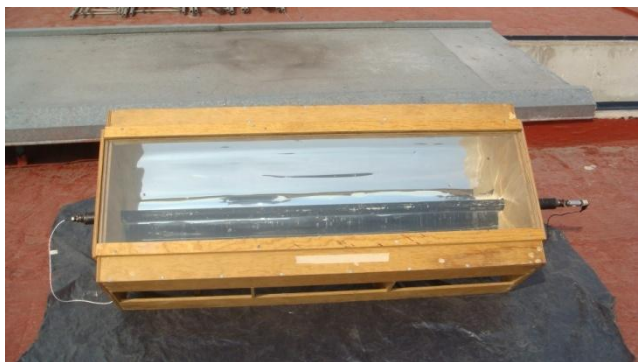
FIGURA 4. Colector solar prototipo. Con este dispositivo se han alcanzado temperaturas de hasta 140 grados centígrados. El ángulo de aceptación es de 15^\circ .
