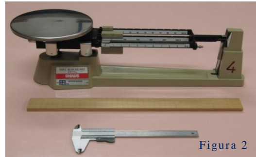
FIGURA 2. Aquí se muestra el equipo que se les proporciona a los estudiantes para que determinen la densidad del alambre.
