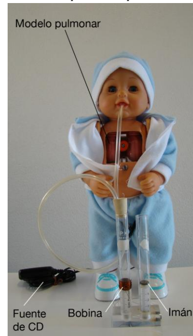
FIGURA 3. Montaje del dispositivo experimental.
