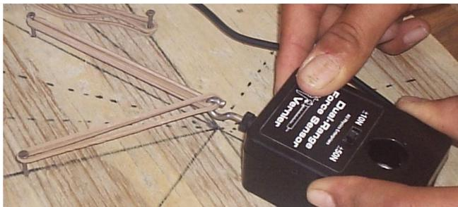
FIGURA 5. Cada liga representa una fuerza previamente medida sobre la línea de acción y la medición de la fuerza resultante se hace sobre la bisectriz del ángulo.
