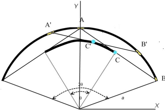
**FIGURA 1.** Un arco de circunferencia con radio  $a$  y ángulo central  $2\theta$ . C y C' son los centros de masa de los pares de puntos ubicados en los extremos de las cuerdas AB y A'B'.
