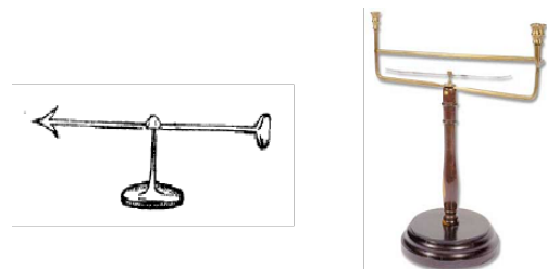
FIGURA 20. Antecesores del electrómetro y el galvanómetro. Izquierda: Versorium de Gilbert. Derecha: Aguja magnética de Ørsted [53].
