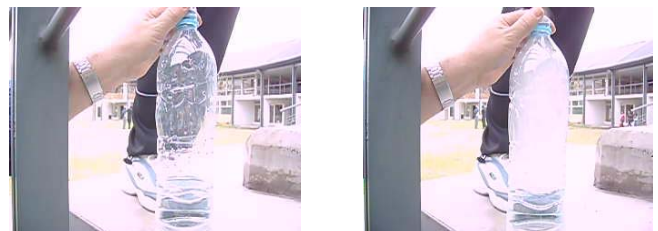
FIGURA 7. Botella de plástico con aire húmedo. A la izquierda vemos la botella presurizada antes de que salte el tapón de goma. A la derecha, la misma botella inmediatamente después que salta el tapón. La nube formada en la descompresión adiabática es claramente visible en el fotograma de la derecha.
