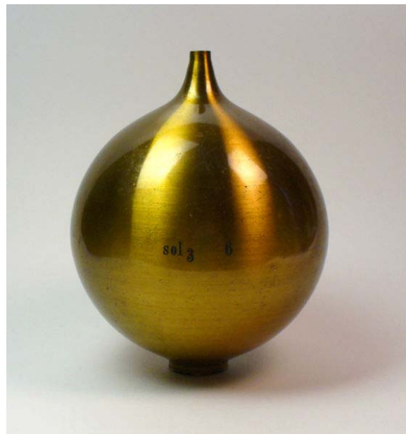
FIGURA 1. Resonador Helmholtz construido por R. Koenig en el año 1865.
