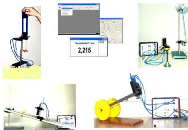
FIGURA 1. Sensor de barrera temporizador contador utilizado para demostrar la gravedad constante a diferentes pesos, la incidencia del momento de inercia en cuerpos rodantes, la conservación de la energía en el péndulo y la veracidad de las ecuaciones para movimiento parabólico.
