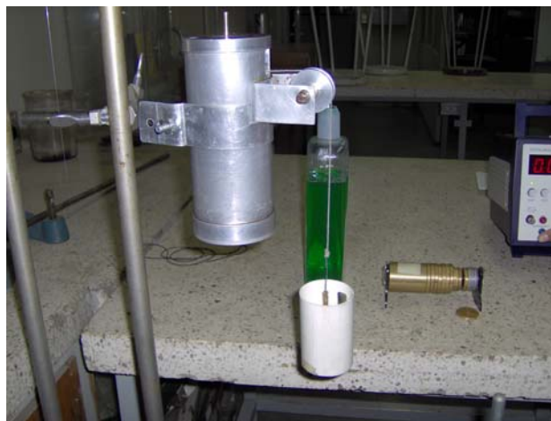
FIGURA 6. Montaje del viscosímetro de cilindros concéntricos.
