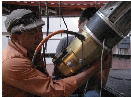
FIGURA 9. Acoplado el espectrógrafo Boller & Chivens al telescopio de 1m.
