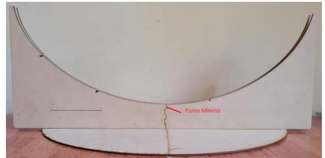
**FIGURA 2.** Diseño curva cicloide. El enlace con el diseño se encuentra en la sección de anexos.
