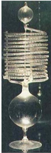
**FIGURA 5.** Termómetro de Florencia de la mitad del siglo XVII. El alcohol contenido en la bola inferior se contrae o se expande con la temperatura. Sus variaciones de volumen son tales que un largo tubo de vidrio en espiral con 50 graduaciones es necesario para medirlas. En invierno, bajaba a 7 grados y subía hasta 40 grados en verano.
