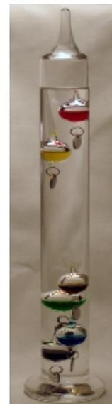
FIGURA 2. Termoscopio llamado "de Galileo" de fabricación comercial actual (Universidad de Le Mans, Francia). Su tubo contiene objetos (de 5 a 8) que flotan, cada uno con una temperatura escrita. La temperatura ambiente está comprendida entre la del más alto y del más bajo objetos que flotan. La precisión
