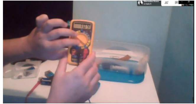
FIGURA 12. Nesta imagem o estudante manipula, durante a aula, o multímetro na escala de voltímetro para medir a ddp de diversas pilhas e baterias.
