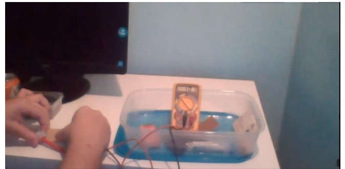
FIGURA 13. Nesta imagem o estudante manipula, durante a aula, o multímetro na escala de ohmímetro e faz leituras de vários resistores.
