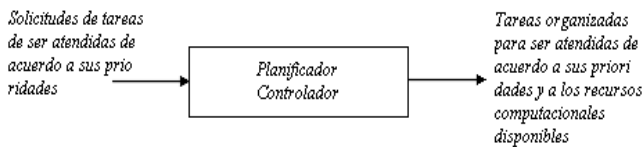
FIGURA 1. Se muestra el diagrama a bloques de un planificador-controlador donde en la entrada están las solicitudes de las tareas que desean ser atendidas y en la salida el conjunto de tareas organizadas por el sistema.
