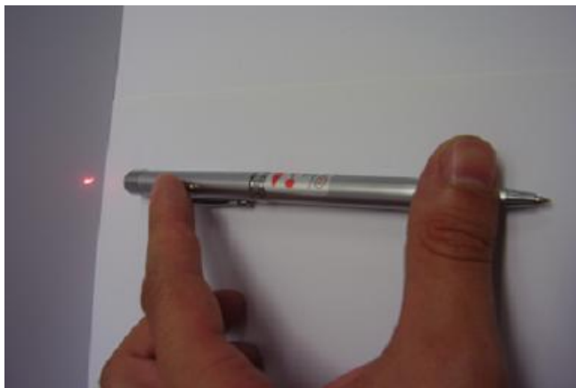
FIGURA 3. Puntero láser utilizado para la obtención de los hologramas.
