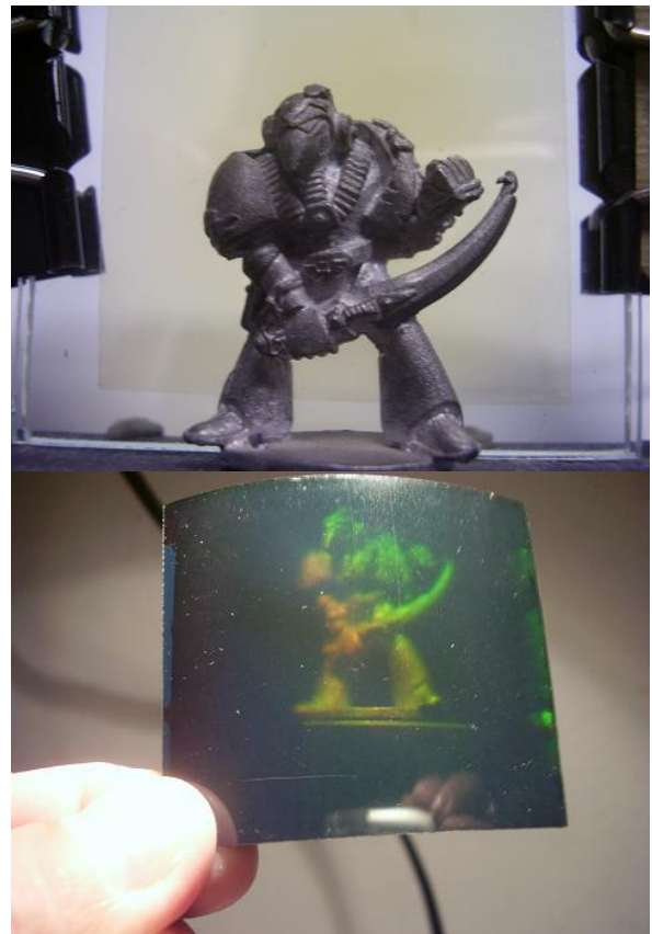
FIGURA 5. Se muestra en la parte superior el objeto holografiado y debajo el holograma obtenido.
