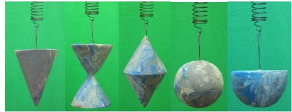
**FIGURA 1.** Fotografías de los objetos puestos a oscilar, haciendo uso de la misma masa se elaboraron, respectivamente; un cono, un diábolo, un cono doble, una esfera y media esfera.
