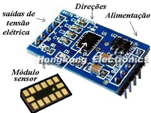
**FIGURA 1.** Foto do sensor acelerômetro capacitivo com as principais funções indicadas. Em destaque na parte inferior da figura temos o módulo sensor *MM7361* fabricado pela empresa *Freescale*. Esta ilustração foi adaptada a partir de figura obtida no site da empresa que comercializa o sensor ([www.tato.ind.br](http://www.tato.ind.br)).
