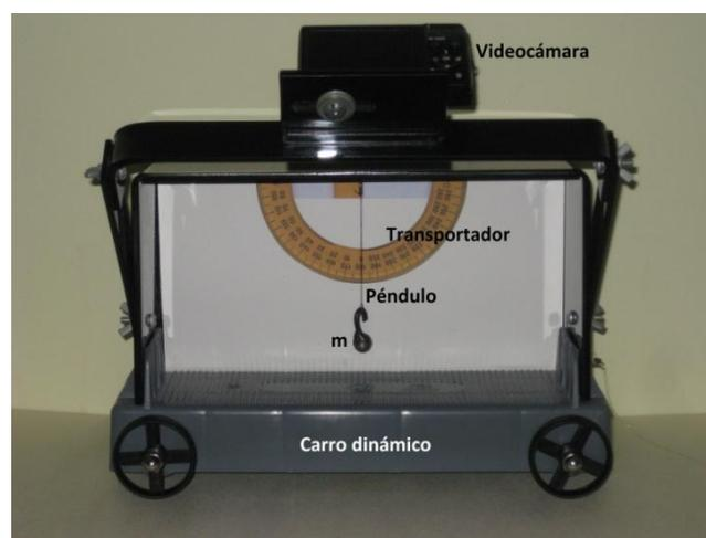
FIGURA 1. Imagen del carro dinámico con un péndulo al interior y una videocámara.
