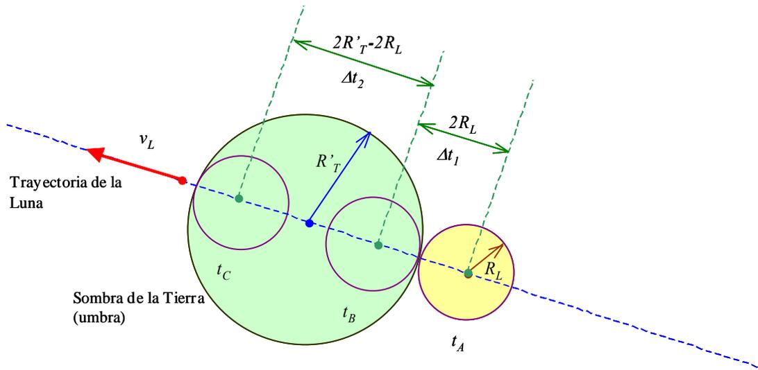
**FIGURA 3.** Esquema de un eclipse lunar.  $R'_T$  es el radio de la sombra de la Tierra y  $R_L$  es el radio de la Luna. Para aplicar el método de Hiparco, es importante que la trayectoria de la Luna pase por el centro de la sombra de la Tierra.
