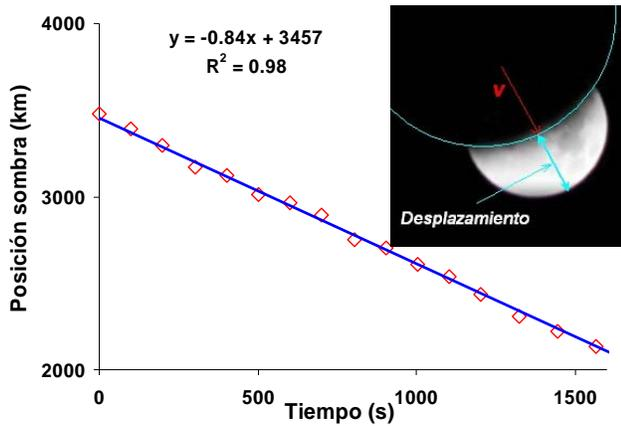
**FIGURA 8.** Posición de la sombra del eclipse respecto del borde de la Luna o equivalentemente de la Luna respecto de la sombra terrestre. En la figura inserta en el gráfico se indica como se determina este desplazamiento. La pendiente de este gráfico nos da la rapidez con la que se desplaza la Luna en la umbra.
