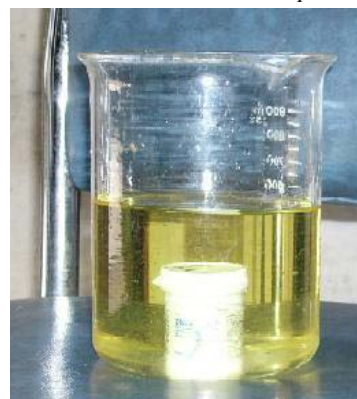
FIGURA 2. El frasco se hunde en el aceite.
