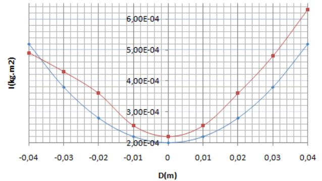
**FIGURA 5.** Curvas de  $I$  vs.  $D$  para la Varilla rectangular. Los valores teóricos son indicados en puntos y línea en azul, mientras que los valores experimentales son presentados en puntos y línea en rojo.
