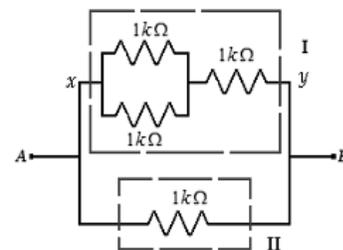
FIGURA 7. Reducción del circuito a dos bloques.
