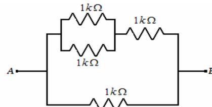
FIGURA 6. Circuito con resistores de igual resistencia.
