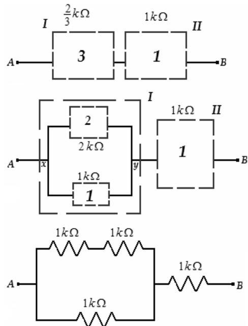
FIGURA 14. Arriba se observa la primera reducción en bloques, en el centro la segunda reducción y abajo se muestra el circuito dual final con resistencia efectiva  $5k\Omega/3$ .
