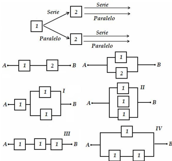
**FIGURA 15.** Arriba se muestra las combinaciones posibles de los bloques, en el centro las configuraciones de los bloques más extremos y abajo la configuración completa con bloques que contienen solo un resistor.
