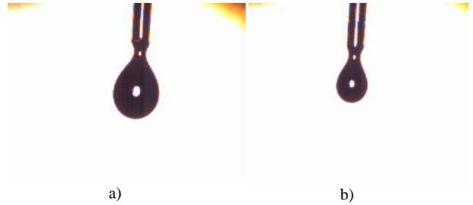
**FIGURA 2.** Imágenes captadas con cámara de alta velocidad del proceso de descuelgue de una gota de la jeringuilla, a) Gota de agua, b) Gota de etanol.
