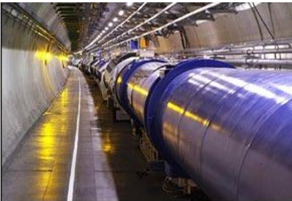
**FIGURA 1.** El túnel del LHC con algunos de los elementos magnéticos dipolares.
