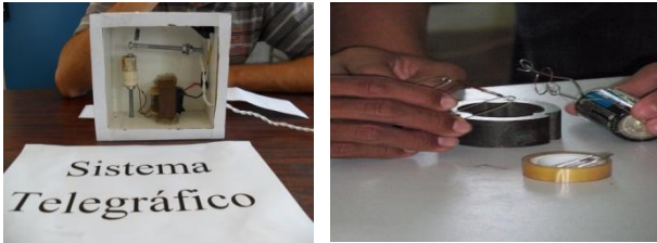
FIGURA 4. À esquerda observa-se o experimento que mostra o funcionamento de um telégrafo e à direita uma demonstração do fenômeno da indução eletromagnética nos motores elétricos.
