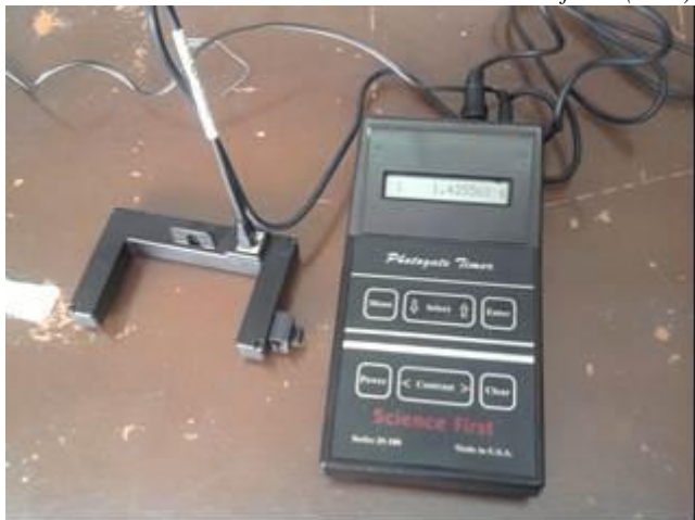
FIGURA 3. Equipo de medida de tiempo de las oscilaciones.
