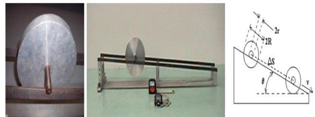
**FIGURA 4.** Disco rolando sem escorregamento através de um plano inclinado.
