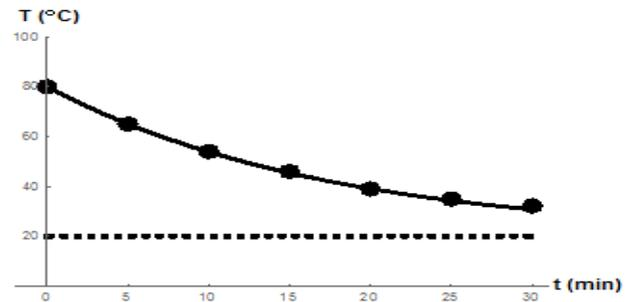
**FIGURA 9.** Temperatura contra el tiempo de enfriamiento. Datos “experimentales” del Problema 1 (círculos) y ley de enfriamiento de Newton (línea continua). La temperatura del medio ambiente es  $20\text{ }^\circ\text{C}$  (línea horizontal a trozos).
