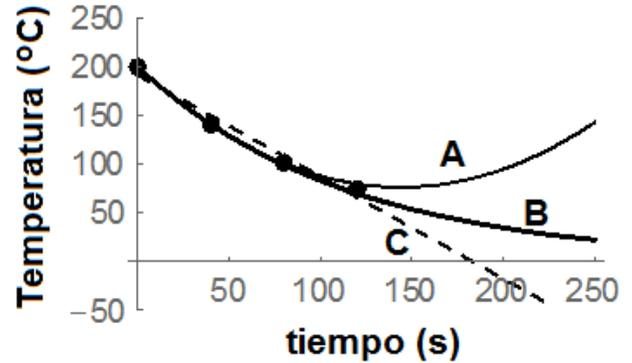
**FIGURA 5.** Traducción del problema que aparece en la referencia [6]. La gráfica de temperatura contra tiempo es muy similar a la proporcionada en esta referencia. La curva del modelo cuadrático (A) se obtiene de la ecuación (10), la del modelo lineal (C) proviene de la ecuación (11) y la del modelo exponencial (B) se desprende de la ecuación (12).
