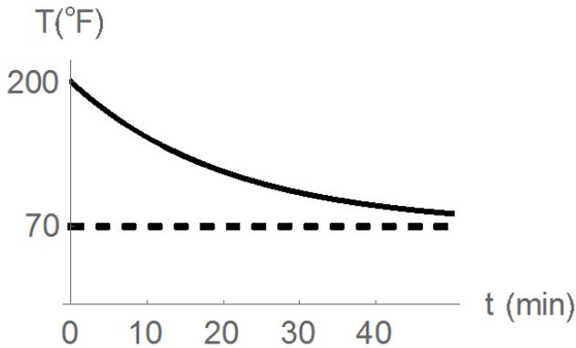
**FIGURA 11.** La curva de temperatura vs. tiempo es muy similar a la que aparece en la Figura 7 de la referencia [4]. En la gráfica original, la asíntota horizontal se etiquetó con  $T = 70$  y la curva cóncava con la expresión  $T = 70 + 130e^{-0.04855t}$ .
