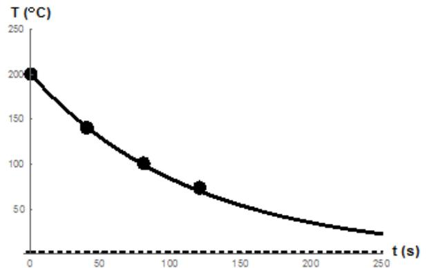
**FIGURA 10.** Temperatura del enfriamiento del material involucrado en el Problema 2 como función del tiempo. Comparación de los datos “experimentales” [6] (círculos) con la ley de enfriamiento de Newton (línea continua). La asíntota horizontal  $T(t)=0\text{ }^\circ\text{C}$  da cuenta de la temperatura del medio ambiente (línea a trozos).
