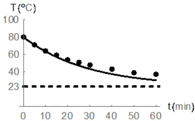
FIGURA 12. Temperatura contra el tiempo de enfriamiento: nuestros datos experimentales (círculos) y ley de enfriamiento de Newton (línea continua). La temperatura del medio ambiente es 23°C (línea horizontal a trozos).
