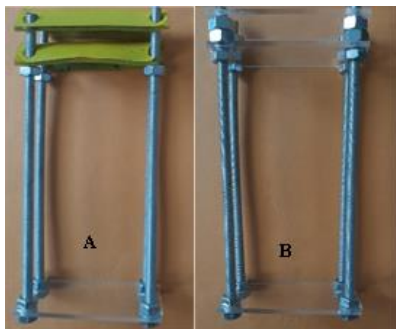
FIGURA 4. Modelos rompeolas construidos. A) Rompeolas DAPT, B) rompeolas DFPT.
