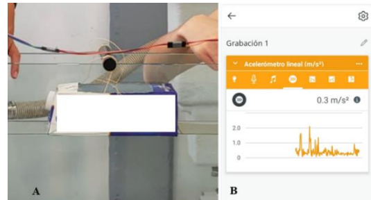
FIGURA 7. A) Celular sobre la superficie libre del agua, B) lecturas del acelerómetro lineal del celular.
